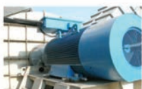
Silniki chłodzone ociekowo IC411 od 200 kW do 2500 kW
