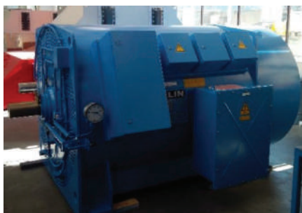
silnik HKM 111R18 5000 kW, 10 kV 50 Hz napęd do pompy, Elektrownia Kozienice
