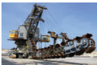
Koparka łańcuchowa Typ: ERs 710 Wydajność: 1,400 m 3 /godz.
