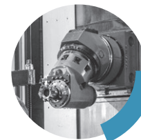
GŁOWICA CENTRALNA PIONOWA (SYSTEM BOX IN BOX)
