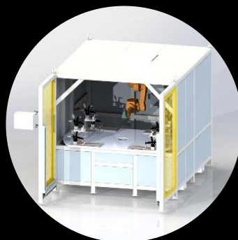
Półautomatyczna stacja AOI ze stołem obrotowym
