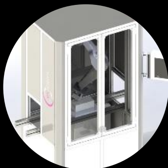
Stacja AOI in-line z kamerą na robocie.
