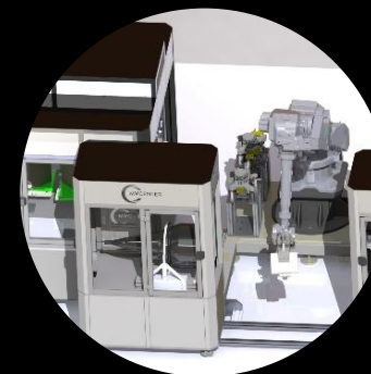
Stacja AOI z kamerą/skanerem nad przenośnikiem
